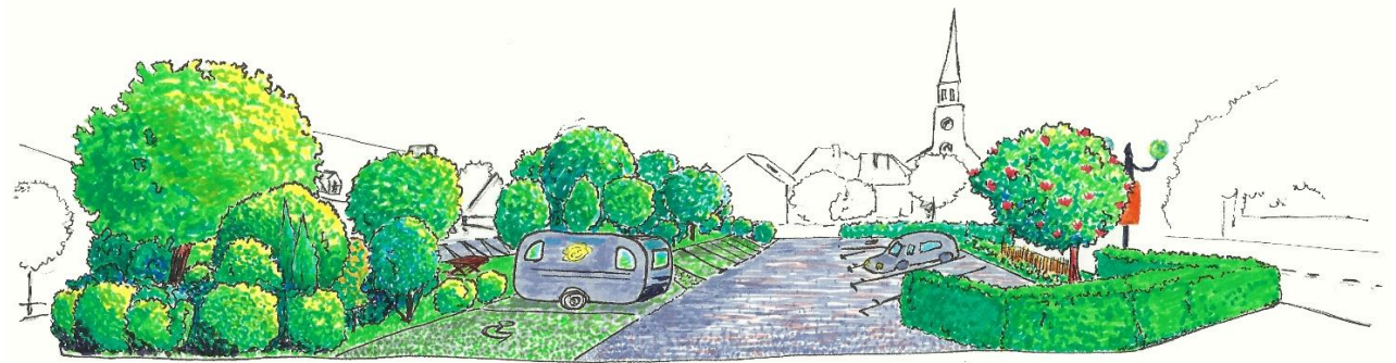
Noue arborée et mélange terre-pierre enherbé pour un parking végétalisé au Minihic-sur-Rance
