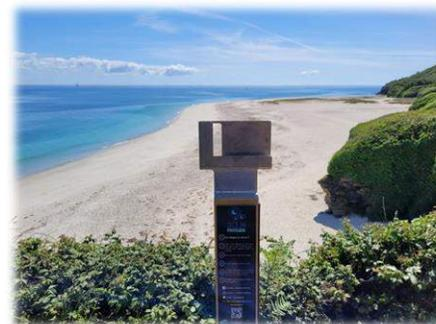
Le LGO a importé le système CoastSnap en France. Ce dispositif originaire d'Australie permet d'analyser grâce à une série d'algorithmes des photos envoyées par les citoyens depuis des stations fixes. Les stations observent l'évolution du littoral tout en sensibilisant les citoyens sur les problématiques côtières.
