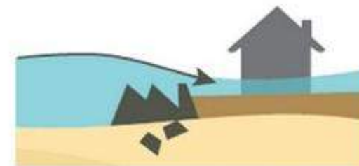
submersion par rupture d'un ouvrage ou d'un cordon dunaire
