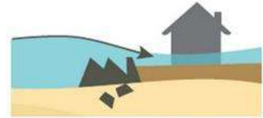
submersion par rupture d'un ouvrage ou d'un cordon dunaire
